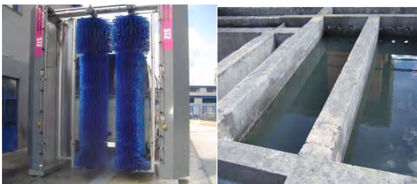
Slika 5.4. Sistem mašinskog pranja i kolektor povratne vode
