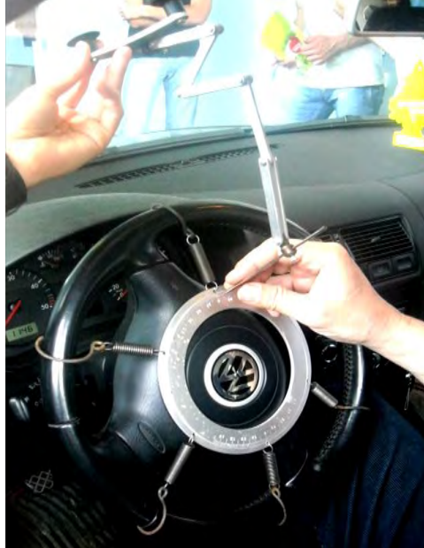
Slika 4.13. Merenje slobodnog hoda točka upravljača uglomerom
