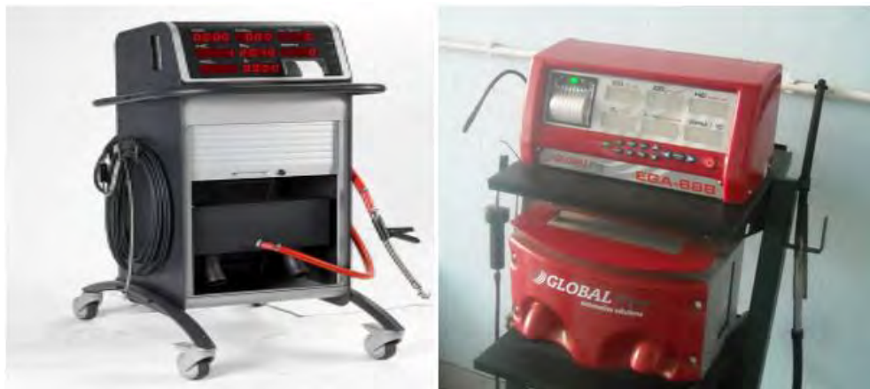
Slika 4.9. Uređaj za merenje zatamnjenosti izduvnog gasa kod dizel motora (levo) i kod oto motora (desno)
