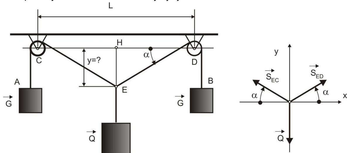
Pošto je uže elastično i nerastegljivo, a trenje i dimenzije koturova C i D zanemarljive sile u užadima  $S_{ED}$  i  $S_{EC}$  su jednake i jednake težini G. Pošto je postakom definisano da je tačka E na sredini između D i C to su i uglovi užeta sa horizontalom u tačkama C i D  $\alpha$  jednaki.
