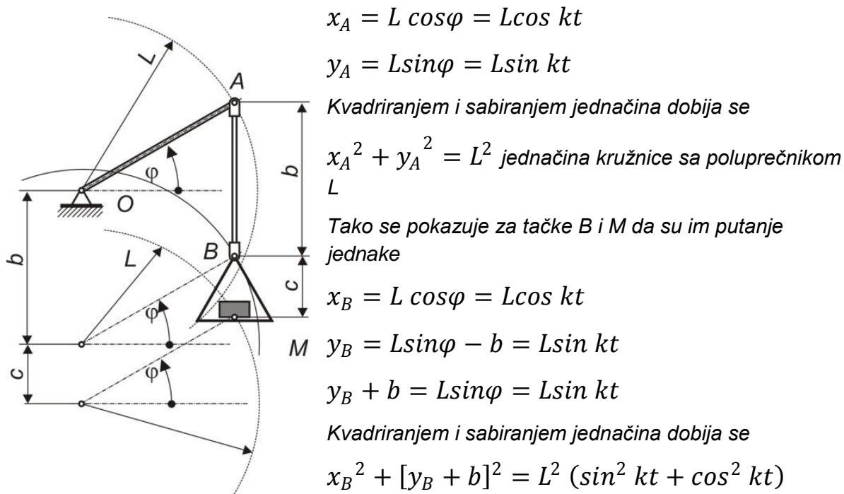
$$x_B^2 + [y_B + b]^2 = L^2 \text{ kružnica poluprečnika L pomerena za } b \text{ po y osi}$$
