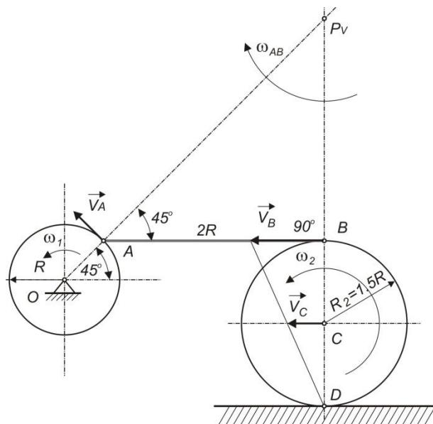
Kako se disk okreće ugaonom brzinom  $\omega_1$ , brzina tačke A diska
