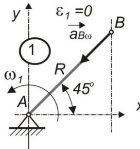
Ugaono ubrzanje tačke diska B je samo ubrzanje usled ugaone brzine jer je ugaona brzina konstantna
