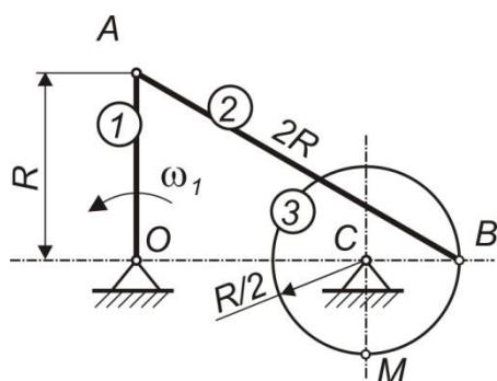
Mehanizam sačinjavaju poluga OA dužine R (označena sa 1, obrće se oko nepomične ose, koja je normalna na vertikalnu ravan u kojoj je mehanizam, konstantnom ugaonom brzinom  $\omega_1$  oko centra O), poluga AB (dužine 2R, označena sa 2) i disk 3 (označen sa 3, prečnika R, obrće se oko nepomične ose C).
