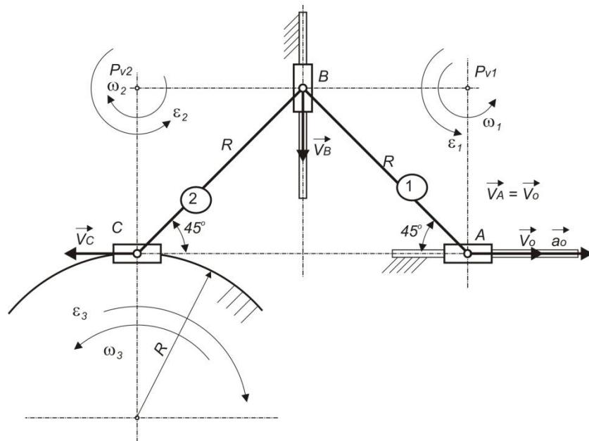
Kako je tačka A i tačka poluge AB, koja se okreće sa  $\omega_{AB} = \omega_1$  oko pola  $P_V$  jasno je da je položaj pola kao na slici, u preseku normale na  $V_A$ , u tački A i normale na  $V_B$  (brzina u tački B mora biti vertikalna pa je u tački B normala na brzinu B horizontalna).
